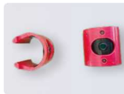
防冻管夹 尺寸: 内径 25MM 颜色: 红色、白色 用途: 用于冷库的空气采样, 防止结冰堵塞采样孔
